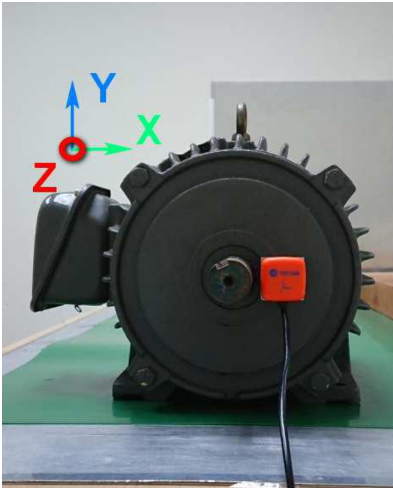
採用軸向安裝位置時，圖示代表為測得的正確振動軸向
